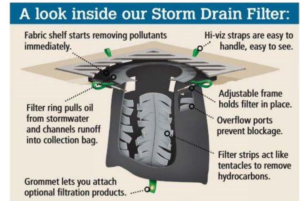
FILTER SOCK SCALE: N.T.S.
